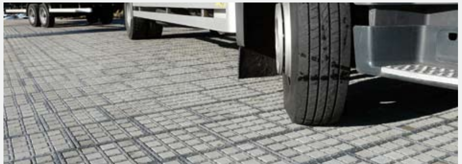
TTE® LKW-Fahrstraße auf nur ca. 25 cm mineralischer Tragschicht auf lehmigem Boden, verfüllt mit TTE®-Pflastersteinen. Die enorme Wasserdurchlässigkeit (ca. 30 l/m 2 pro Sekunde) verhindert Pfützenbildung und tilgt Feinstaub.
